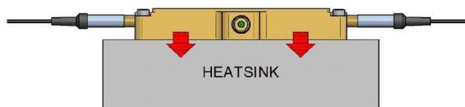
为了帮助热传导，必须在 Fiber-Q® 外壳和散热器之间的接触面上确保热接触。要实现这一点，请：
